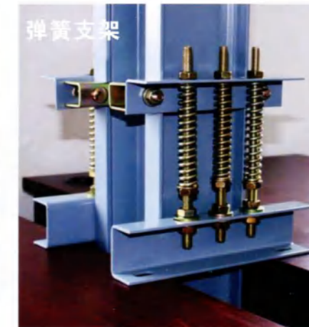
弹簧支架 用于母线在楼层垂直段的支撑和槽钢固定每条线路每层需要1套
