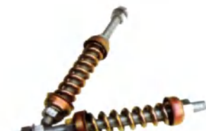
图8 弹簧螺栓 适用于垂直母线安装，能均匀分布重量， 自动适应母线轴向伸缩变化量。
